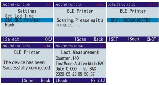
Después de seleccionar [Configurar impresora BLE], el dispositivo buscará automáticamente la impresora Bluetooth cercana que esté abierta y no conectada a la impresora Bluetooth. Después de buscar la impresora Bluetooth, haga clic en el botón derecho para conectarse; si no buscó en la impresora especificada, haga clic en Escanear para buscar. de nuevo.
