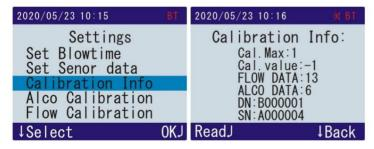
Esta interfaz puede revisar el código de calibración de concentración de alcohol, el código de flujo; Número de serie de la máquina y del módulo del sensor.
